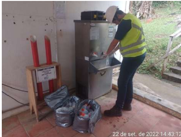
Foto 71 – Coleta de água para análise de potabilidade – Bebedouro Canteiro Administrativo. (Data:22/09/2022)
