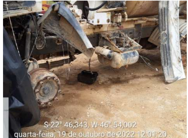
Foto 32 – Contenção decorrente de vazamento de equipamento. (Data:19/10/2022)
