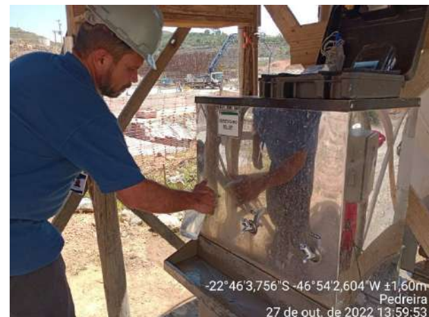
Foto 76 – Coleta de água para análise de potabilidade – Bebedouro da Fundação. (Data:27/10/2022)
