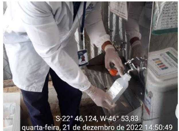
Foto 84 – Coleta de água para análise de potabilidade – Bebedouro da usina de concreto. (Data:21/12/2022)
