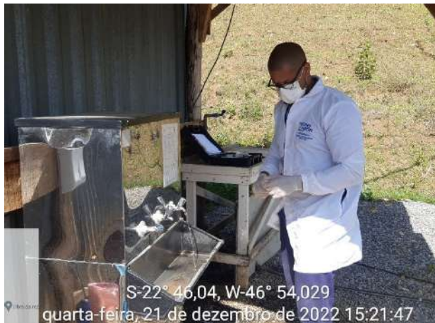
Foto 83 – Coleta de água para análise de potabilidade – Bebedouro do container da fundação (Data:21/12/2022)
