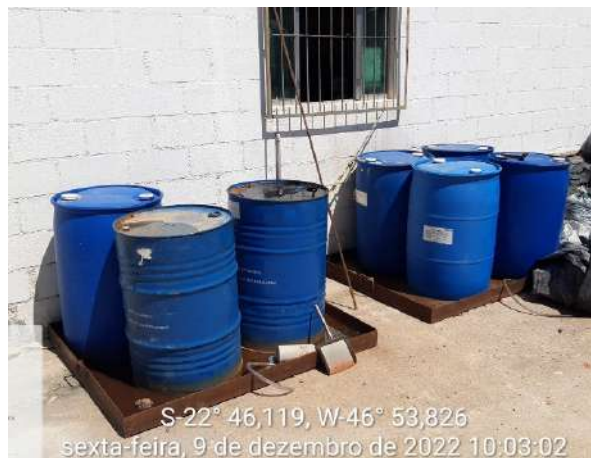
Foto 42 – Vista de tambores de aditivos dispostos em bandejas de contenção na frente de serviço. (Data:09/12/2022)
