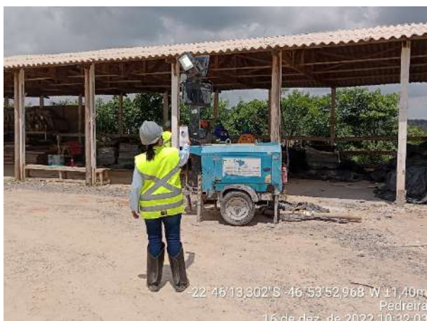
Foto 223 – Medição de fumaça preta da torre de iluminação. (Data:16/12/2022)
