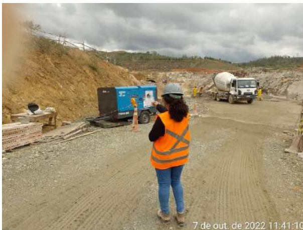
Foto 219 – Medição de fumaça preta no compressor. (Data:07/10/2022)
